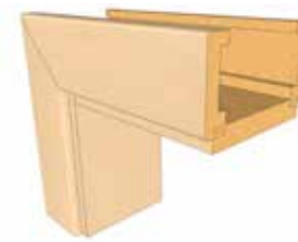
Řez obložkovou zárubní průchozí (OKZ) přes původní kovové zárubně síla zdi od 5 cm, límce 8 cm
