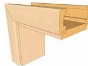
Řez obložkovou zárubní průchozí síla zdi od 5 cm, límce 6 cm
