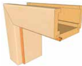
Řez obložkovou zárubní (OKZ) přes původní kovové zárubně síla zdi od 5 cm, límce 8 cm
